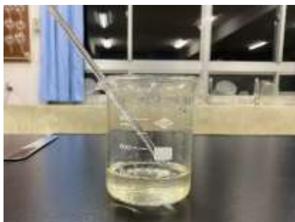
図2 水 50ml に対し、砂糖を 5g ずつ溶かし 55g まで溶かし続けた結果
